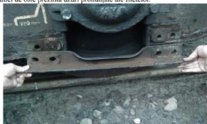
Legătură de gardă cazută de la fusul nr. 5 al vagonului nr. 87 53 7960 756-2
